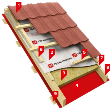
Рис. 6. Строение кровельной системы ТН-ЛЮКСАРД Мансарда
